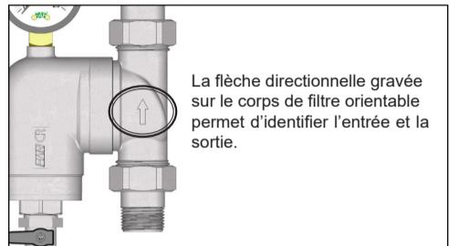
La rotation des raccords permet, quant à elle, d'installer le filtre tant sur des tuyaux horizontaux que sur des tuyaux verticaux.
