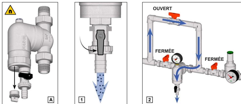
Pour effectuer un nettoyage plus soigné, une fois les vannes à bille fermées (**Figure 3**), dévissez le corps inférieur à l'aide d'une clé et retirez la cartouche filtrante (**Figure 4**). Après avoir éliminé toutes les impuretés du filet filtrant, replacez la cartouche sur le corps inférieur du filtre et procédez au vissage (**Figure 5**).
