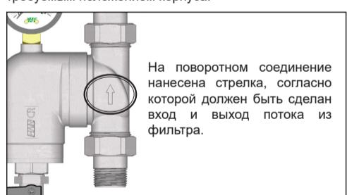
На поворотном соединение нанесена стрелка, согласно которой должен быть сделан вход и выход потока из фильтра.
